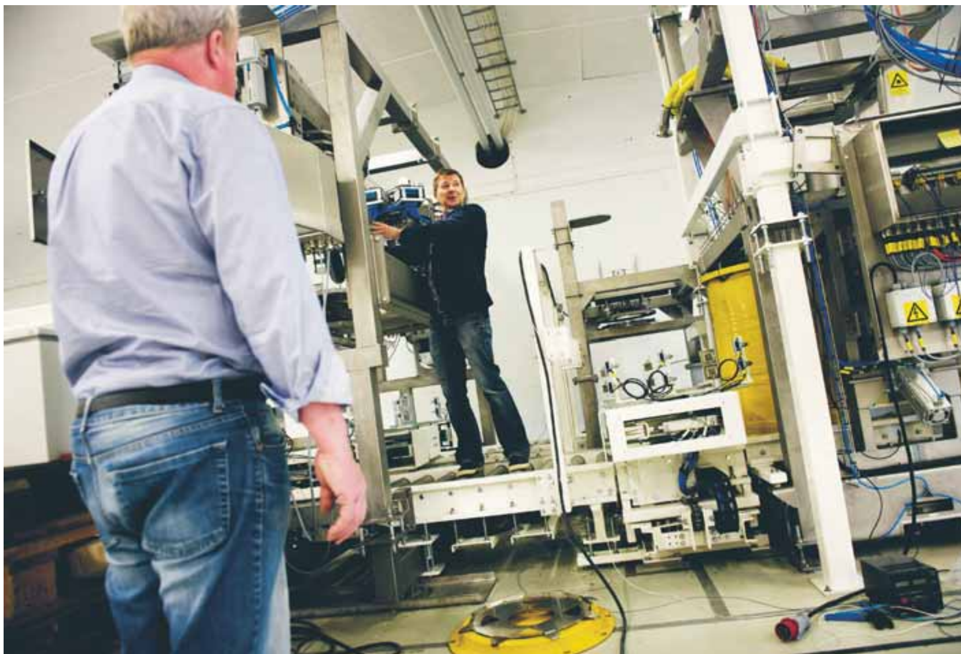
Lennart Åström visar hur Industriksulternas "tva-maskin" fungerar. Driftstopp är otänkbara så alla funktioner är dubblade. Läger en motor av så finns det en reserv som går igång.
